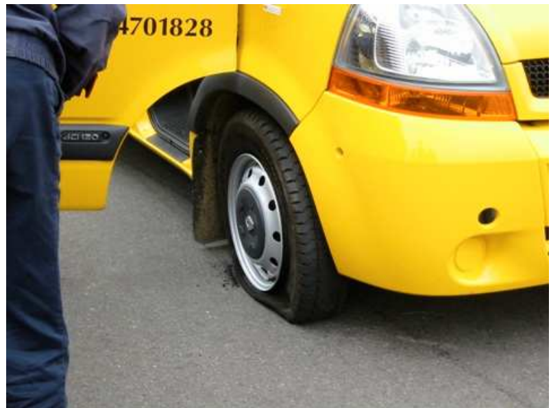
Afbeelding 5: ondanks de lekke band kon flink worden doorgereden. Let op het rubber slijpsel, net achter de band, toch is de band zelf heel gebleven.
