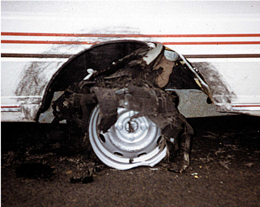
Afbeelding 3: beschadigde wielkast door uit elkaar gespatte band
